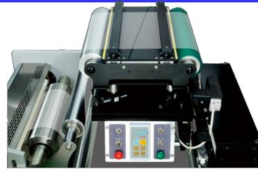
ロール処理には不可欠な蛇行調整、超音波センサー方式のEPC装置でコーティングローラーに入る前に蛇行を無くす。
