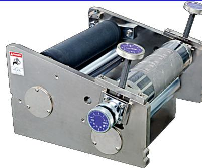
ロール処理の最終商品化を実現するスリッターとダイカットユニット(定寸カットのみ)です。後加工でのワンプス処理が可能となります。
